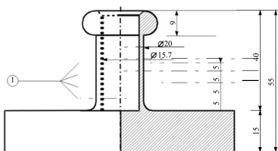
Sl.3: Šuplji cilindar; bronca, zatvoren s jedne strane planirati i usjeći dimenzije u mm
