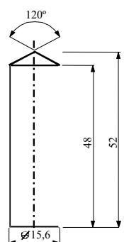
Fig.2: Cilindrični brončani klip,
